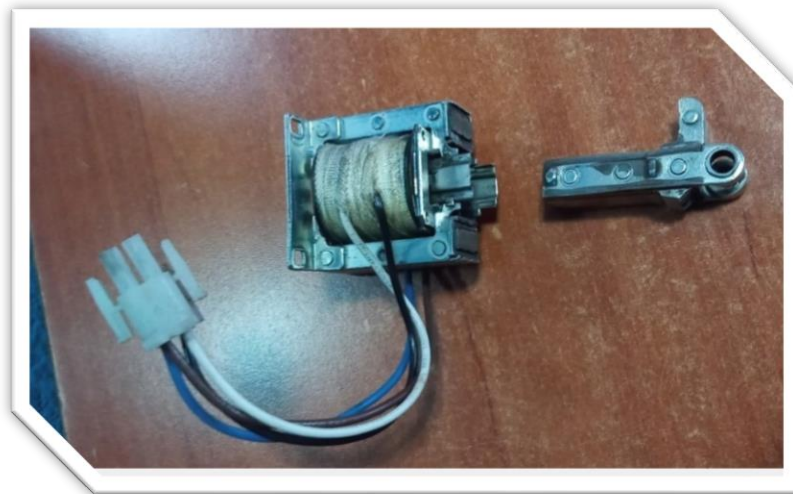
Solenoides en mal estado
